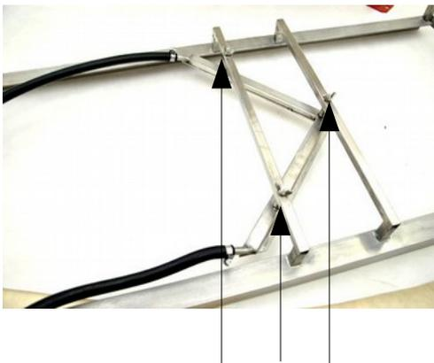
Винты для регуляции распечатывающего ножа находятся под ножом.
