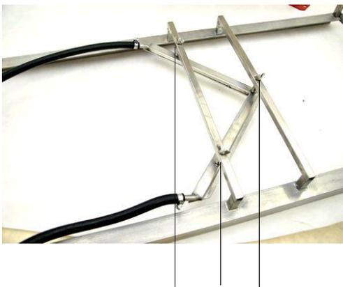
Винты для регулировки высоты ножей находятся под ножами
