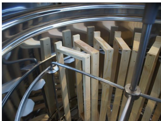
фото.1 Правильное расположение рамки внутри радиальной медогонки
