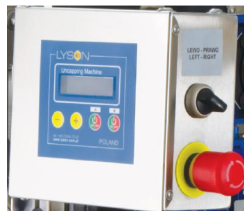
Фото 19 Аварийная кнопка «СТОП» А
